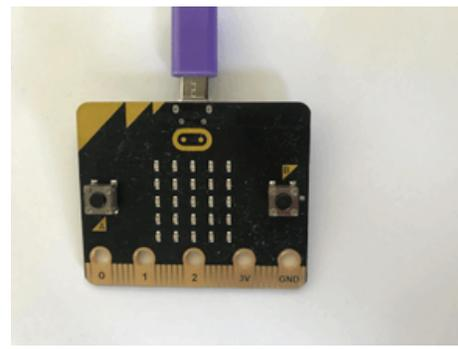
Brancher le fil USB à l'ordinateur (pas un iPad) et à l'autre extrémité du fil dans le micro:bit. Les iPads peuvent être utilisés avec l'application micro:bit installée et en utilisant une connexion bluetooth.
